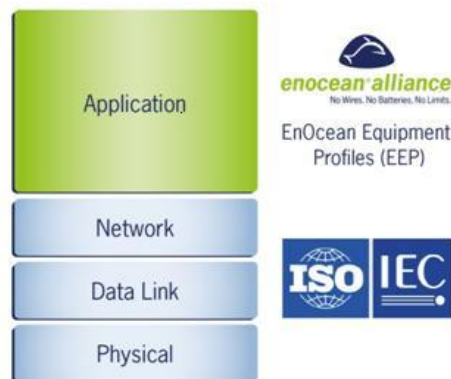
FIGURE 6 – L’EnOcean est un protocole applicatif s’ajoutant sur la norme ISO/IEC 14543-3-1X
